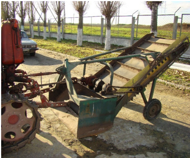
Рисунок 2 – Экспериментальный образец прицепной машины для удаления и погрузки тепличного грунта
