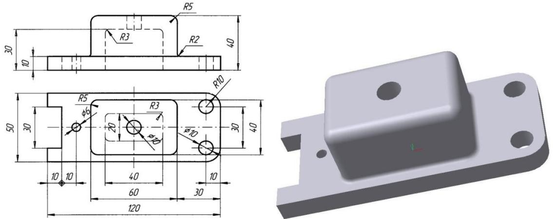
Типовое практическое занятие № 22 Построение детали в аксонометрии по заданному чертежу в системе КОМПАС-3D с помощью операции вращения.
