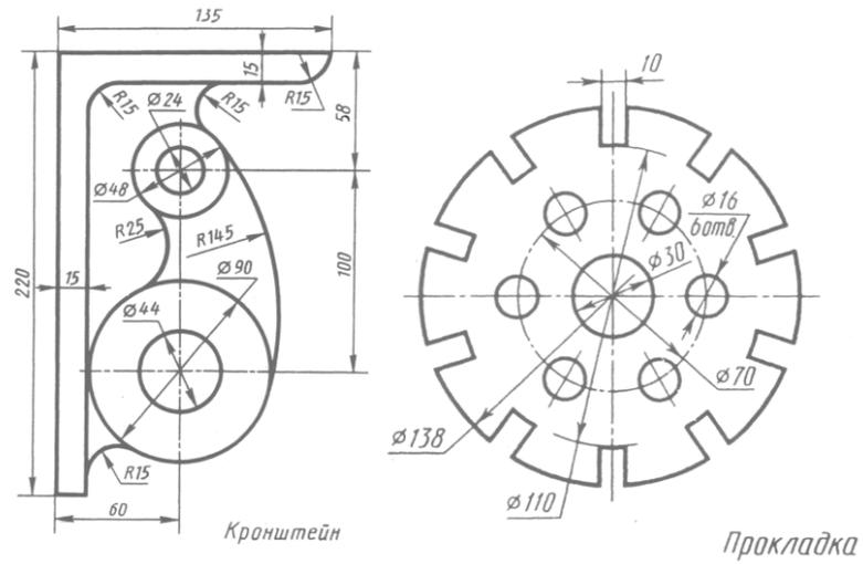
Типовое практическое занятие № 21 Построение детали в аксонометрии по заданному чертежу в системе КОМПАС-3D с помощью операции выдавливания.
