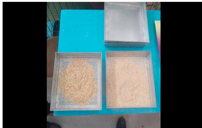
Рисунок 5 – Зерновая смесь после измельчения на сите Ø 2 мм Figure 5 – Grain mixture after grinding using a sieve with Ø 2 mm
